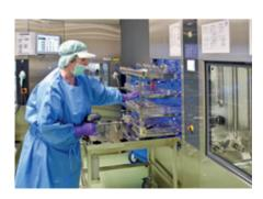
Ausgebreitet auf Siebe werden die benutzten Geräte in die Reinigungsmaschinen geschoben.
