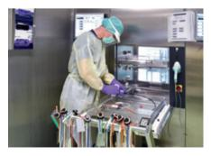
Hitzeempfindliche Geräte, die sogenannten "Kritisch-C-Produkte" wie zum Beispiel Endoskope, werden in speziellen Waschmaschinen bei maximal 60 Grad Celsius gereinigt und dann desinfiziert.
